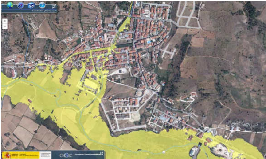
Figura 23. Terrenos afectados por la avenida de 500 años de periodo de retorno según el Sistema Nacional de Cartografía de Zonas Inundables. Fuente: SNCZI. CHS.
