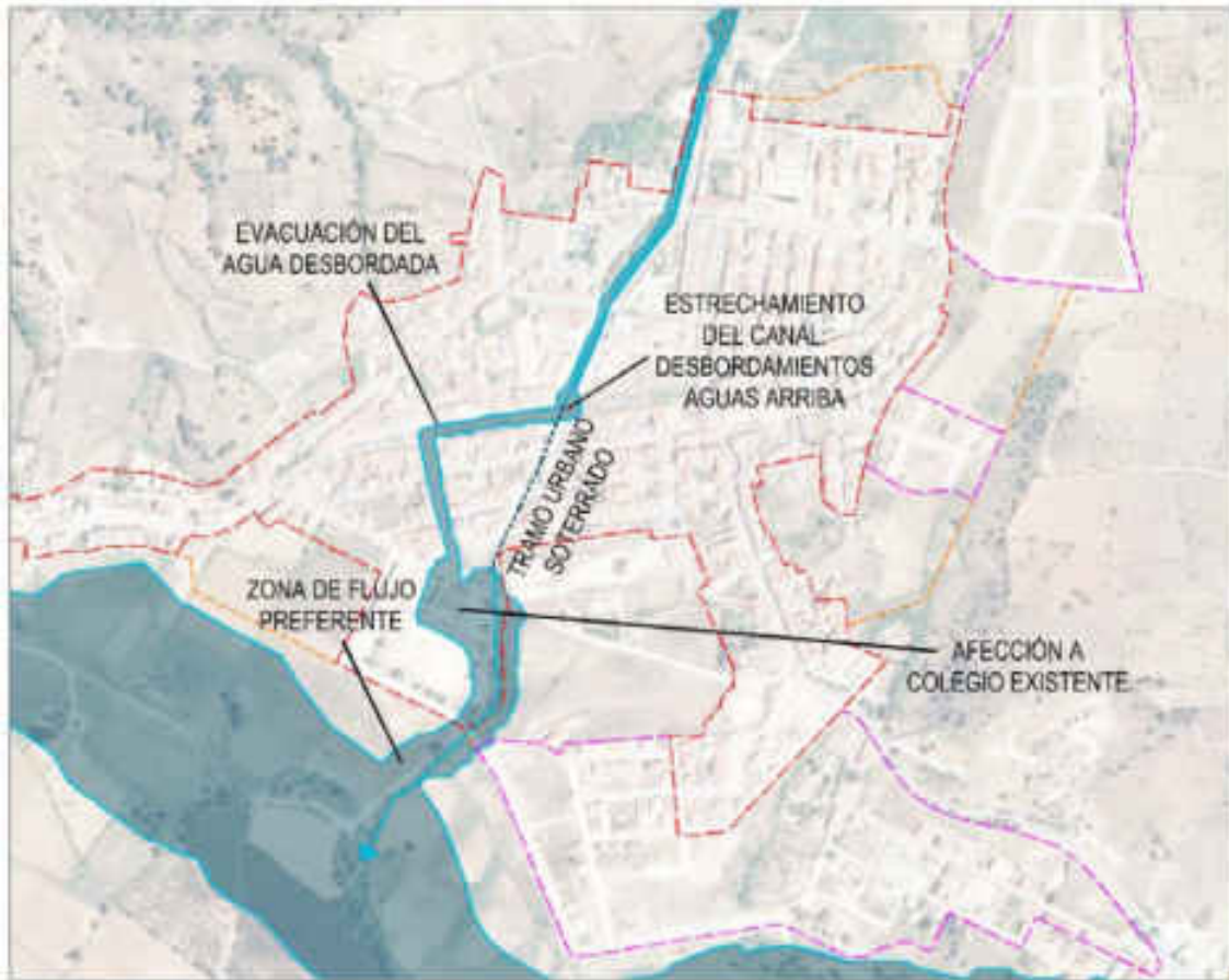
Figura 22. Terrenos incluidos en la ZFP, considerando el desbordamiento producido por la sección insuficiente del tramo soterrado. Afección al Paseo de los Plátanos, calle Benjamín Palencia y Colegio Público existente.
